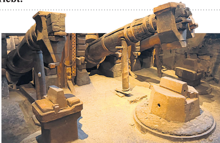
Die Kraft der Worble brachte den historischen Schwanzhammer in Bewegung und machte das Schmieden schwerer Werkstücke möglich
