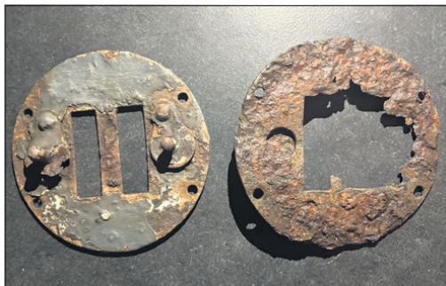
Stark korrodierte Einzelteile, die dank der Ulrich Oppliger AG mittels Laserschneiden neu hergestellt wurden
