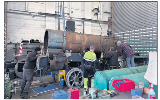
Das Heben des Kessels erforderte Ideenreichtum und Fingerspitzengefühl, da der Lokrahmen inkl. Achsen am Kessel festgerostet war
