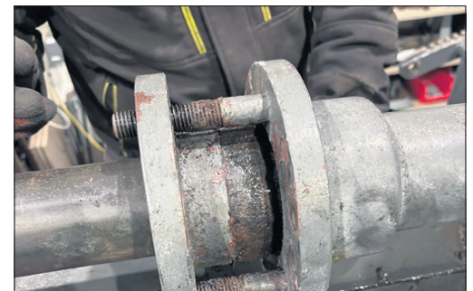
Hier im Bild die Stopfbuchse, welche die Kesselausdehnung kompensiert
