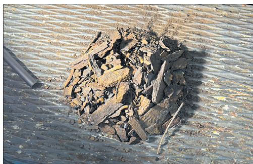
Rost aus der Rauchkammer
